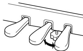
Поворачивайте регулятор высоты до тех пор, пока он не придет в тесный контакт с поверхностью пола.
