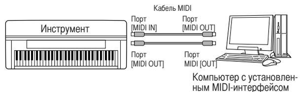
Второй способ подключения – с помощью отдельного внешнего MIDI-интерфейса, подключенного к компьютеру через порт USB или последовательный порт (используемый для модема или принтера). С помощью стандартных MIDI-кабелей подключите порт MIDI OUT внешнего интерфейса к порту [MIDI IN] инструмента, а порт [MIDI OUT] инструмента – к порту MIDI IN внешнего интерфейса.
