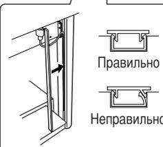
2 Вставьте кабель педали в паз компонента D и установите пластиковую крышку на паз. Не пропускайте соединительную ленту между стенкой пазы и ножкой.
