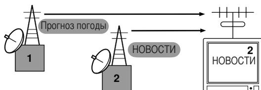
Принцип действия MIDI тот же. Передающее устройство посылает определенному каналу (MIDI Transmit Channel) принимающего устройства сообщения по MIDI-кабелю. Если MIDI-канал принимающего устройства (MIDI Receive Channel) соответствует каналу передающего устройства (Transmit Channel), принимающее устройство будет воспроизводить звук в соответствии с полученными сообщениями.
